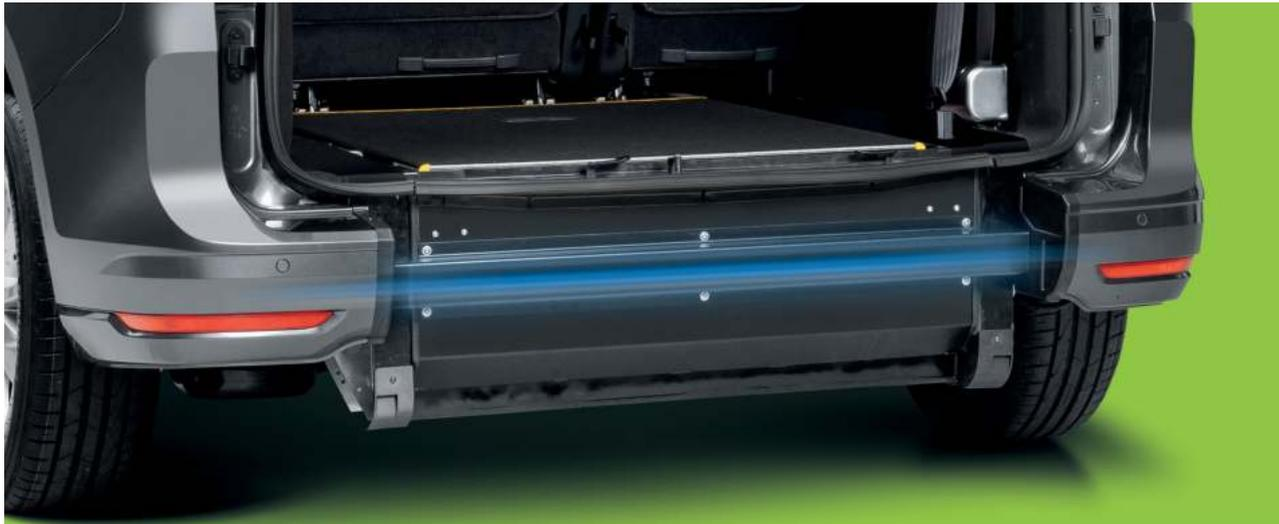
Das einzigartige patentierte Heckaufprallschutzsystem erhöht die Sicherheit der Fahrzeuginsassen deutlich.
